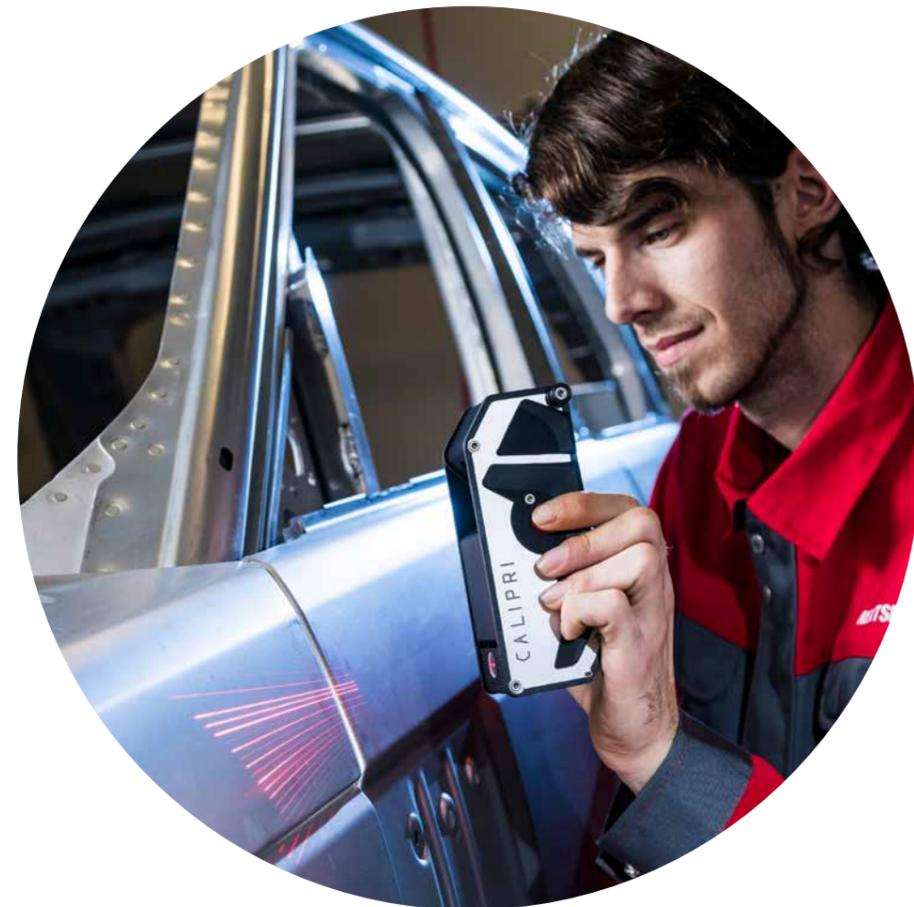
光电轮廓测量仪以非接触形式测量边缘和间隙的截面。通过直观的回转运动可以实现对迄今为止任何复杂轮廓曲线的评估，而无需借助于数学推理。此外，我们专利的倾斜校正功能，完美地杜绝了任何人为因素的影响。
