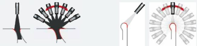
测量方法是基于激光光切技术。操作者或机械臂将传感器移动至待测量轮廓的上方。同时智能的图像处理系统从不同的视角连续采集轮廓的片段，然后将它们整合为一个完整轮廓。CALIPRI 自动补偿传感器的倾斜和扭转。测量结果具有高重复性并不受人为因素影响。
